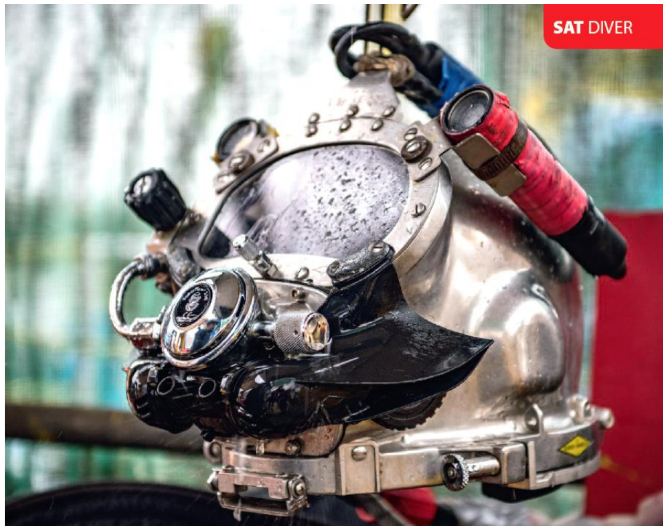
上: 潜水ヘルメットの重量は約 15kg、潜水船と通信するためのカメラと音声機器が取り付けられています。
